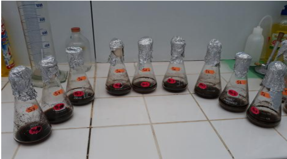
Figure 13: Réalisation des fermentations dans des erlenmeyers de 250 ml.
